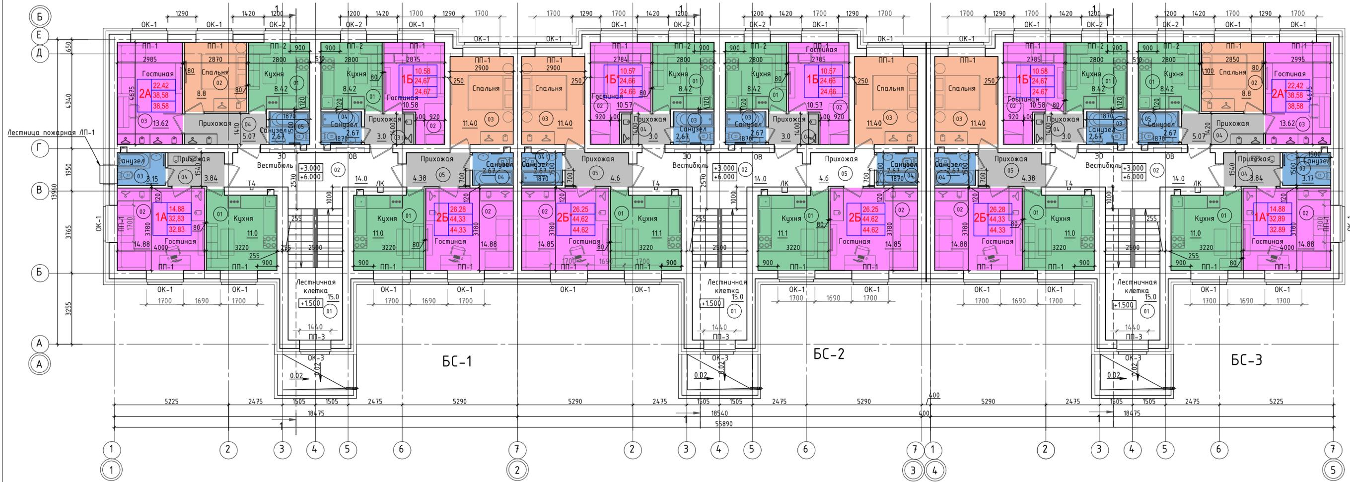
Экспликация помещений типового этажа (2,3 этаж)
